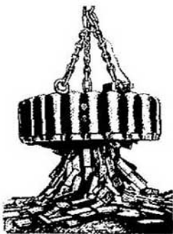
Fig. 94. Una grúa de electroimán transportando planchas de hierro.
