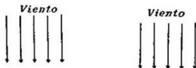
Fig. 19. El viento siempre le empuja a la vela formando un ángulo recto con su plano.
